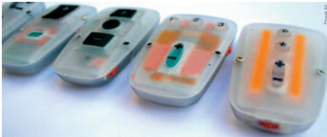
Abb. 2: In den Usability-Tests verwendeten die Benutzer unterschiedliche Hardware-Prototypen der Fernbedienung. Sowohl die physischen Bedienelemente als auch die Tastenbelegungen sowie Funktionen und das Interaktionskonzept der Fernbedienung wurden variiert.
